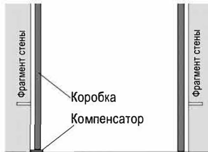
**7.** Закрепите кронштейны к коробке двумя саморезами при нормальной ситуации или четырьмя\* при сильном смещении в проеме (см. рисунок).
